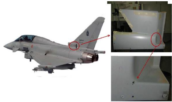
شکل ۲- قسمت بازرسی شده از بدنه هواپیما توسط روش‌های نو و سنتی غیرمخرب [۲۸].
