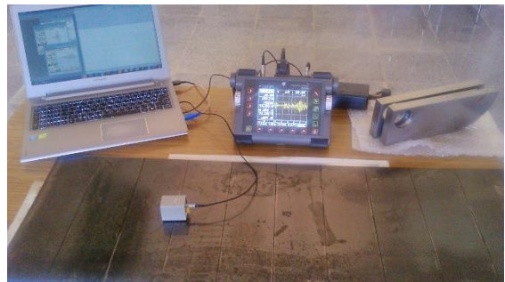
شکل ۴- نحوه قرارگیری پروب زاویه متغیر بر روی سطح ورق فولادی
