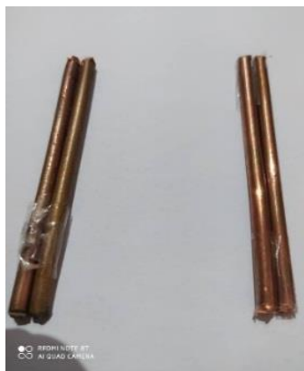
شکل ۵- الکتروودها (الف) قبل و (ب) بعد از استفاده در پلاسمای سرد
