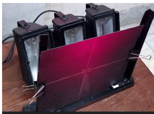
شکل ۸- نمونه صفحه تخت کامپوزیتی به‌همراه سیستم بارگذاری ۳ کیلووات در آزمون برشنگاری لیزری
