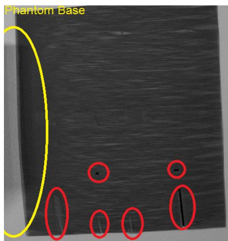
شکل ۳- نتیجه آزمون پرتونگاری با استفاده از اشعه X روی نمونه تخت کامپوزیتی الیاف کربن در انرژی ۲۰ کیلوالکترون ولت
