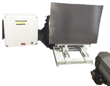
شکل ۵- چیدمان آزمون حرارت‌نگاری فروسرخ در نمونه آزمون صفحه تخت
