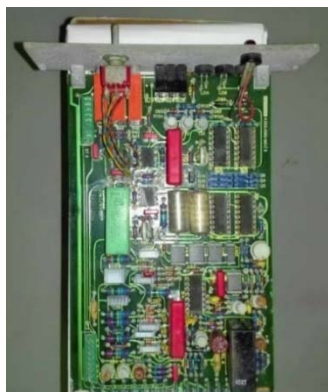
شکل ۲- برد الکترونیکی به عنوان نمونه مورد آزمون برای تصویربرداری مقطع‌نگاری نوترونی
