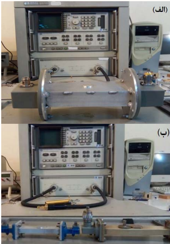
شکل ۶: دستگاه اندازه‌گیری شامل محفظه موجبر مستطیلی و تحلیل‌گر شبکه‌ی برداری: (الف) باند S و (ب) باند X و Ku
