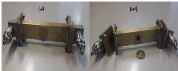
شکل ۲: محفظه موجبر مستطیلی ساخته شده با آداپتور:
