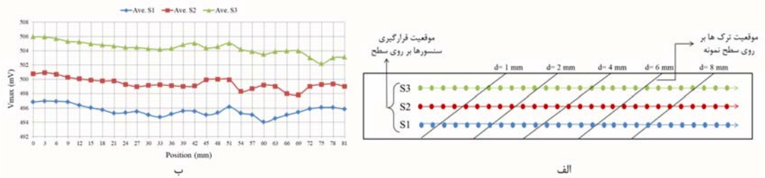
شکل ۹- الف) تصویر شماتیک سطح نمونه فولادی دارای ترک مصنوعی و موقعیت‌های انجام آزمون و ب) منحنی تغییرات بیشینه ولتاژ خروجی بر حسب مکان برای سه سنسور اثر هال مورد استفاده در آزمون نشت شار مغناطیسی با فاصله هوایی میان پایه‌های کوئل و نمونه.
