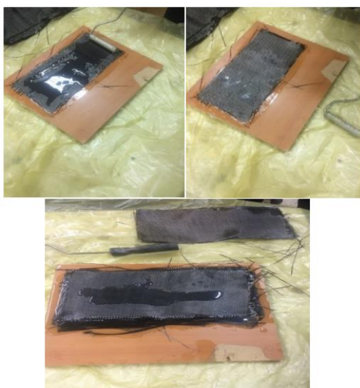
شکل ۳- ساخت نمونه به روش لایه‌گذاری دستی
