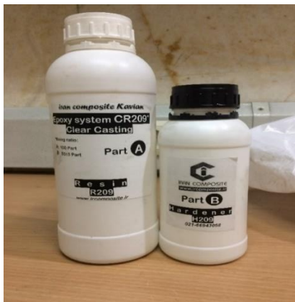
شکل ۲- رزین و هاردنر مورد استفاده در ساخت نمونه‌ها
