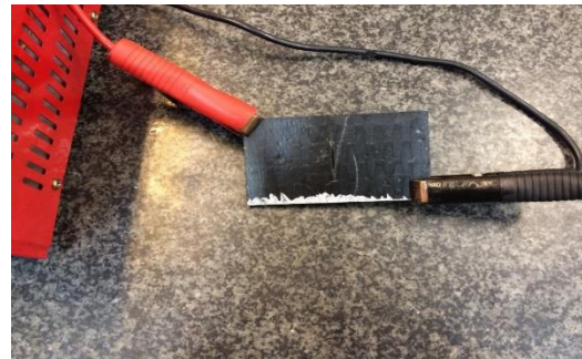
شکل ۶- اعمال جریان الکتریکی به صورت مستقیم به نمونه
