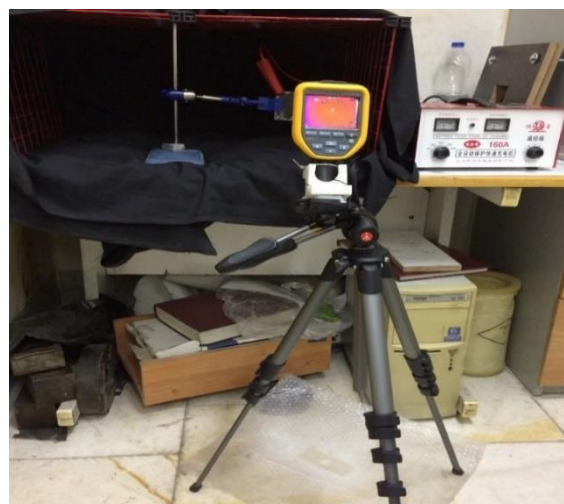
شکل ۷- تجهیزات مورد استفاده در ارزیابی حرارت‌نگاری
