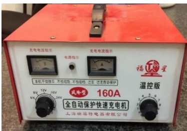
شکل ۵- منبع تغذیه بکار گرفته شده برای اعمال جریان الکتریکی
