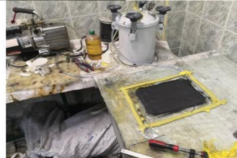
شکل ۴- ساخت نمونه به روش وکیوم اینفیوژن
