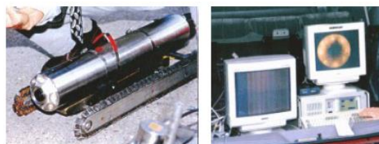
شکل ۱۱- سیستم بازرسی SSET [15]
