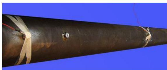
شکل ۲- نحوه قرارگیری سنسورها روی لوله فولادی
