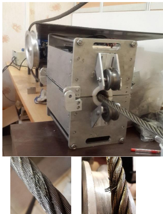
شکل ۱- سامانه آزمون کابل و عیوب آن.
