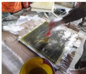
شکل ۲- لایه چینی الیاف به همراه رزین بر روی صفحات قالب
