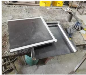
شکل ۱- قالب ساخته شده برای تزریق فوم و لایه چینی
