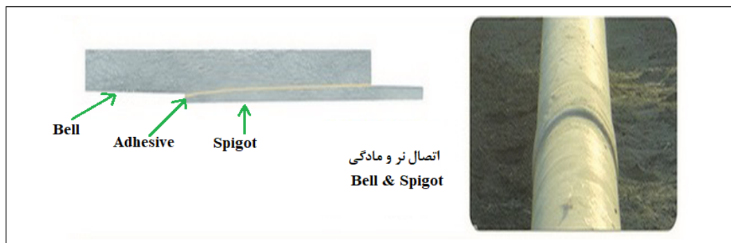
شکل ۱- نحوه اتصال نر و مادگی
