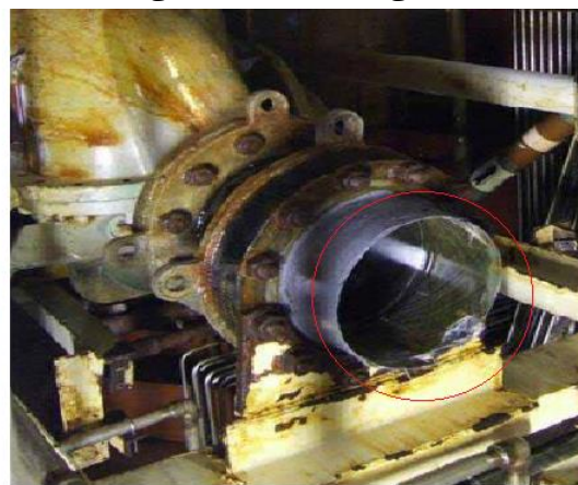
شکل ۲- خرابی دو لوله از محل اتصال چسبی (ریچارد لی [۱۰])
