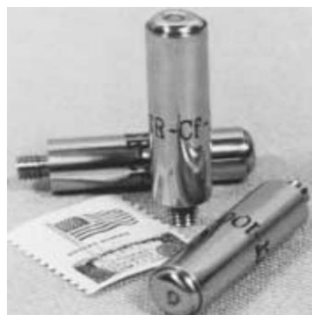
شکل ۳- رادیوایزوتوپ کالیفورنیوم-۲۵۲ برای پرتونگاری نوترونی در مقایسه ابعادی با تمبر پستی
