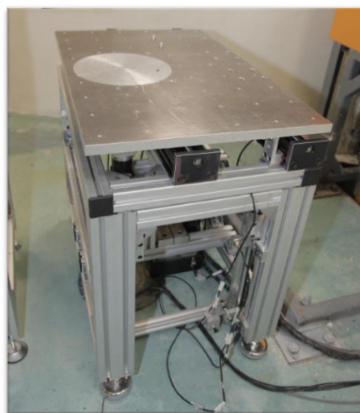
شکل ۷ - میز نمونه با پیش‌بینی‌های توسعه‌ای لازم برای برپایی سامانه تصویربرداری به صورت مقطع نگاری
