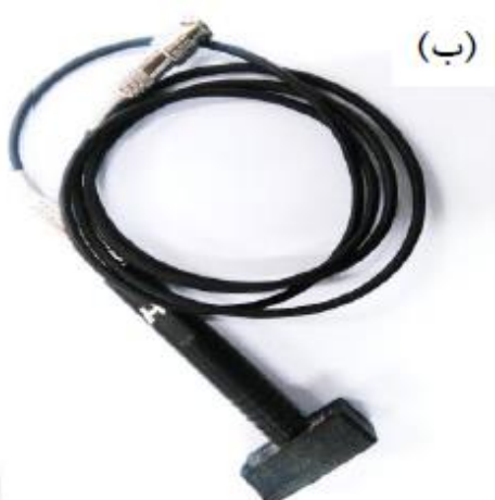
شکل ۴- تصویری از: (الف) دستگاه جریان گردابی پرتابل مدل IH-ECP 104 و (ب) پراب مخصوص مورد استفاده.
