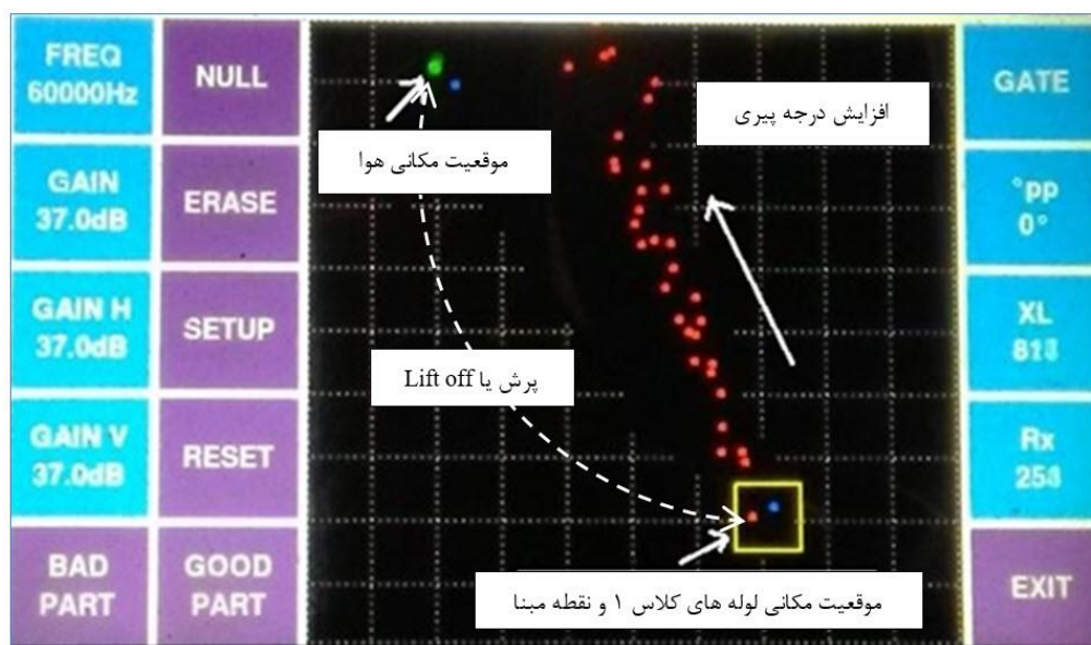
شکل ۹- تصویر نمایش گر دستگاه جریان گردابی و نقشه امپدانسی لوله‌ها با درجه‌های پیری مختلف
