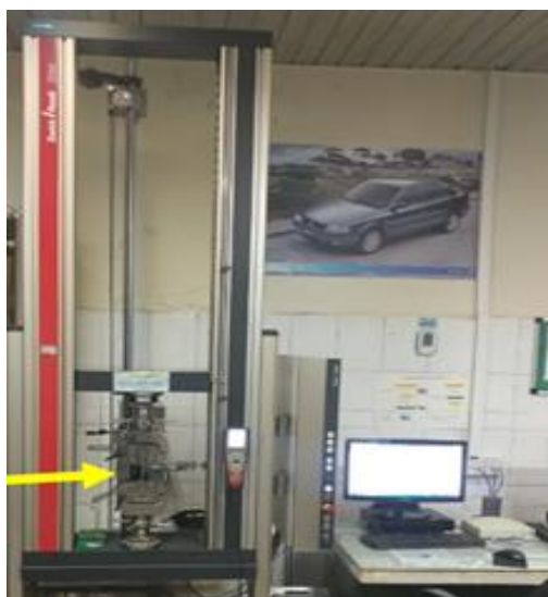
شکل ۴- دستگاه تست کشش-برش مورد استفاده در آزمایش
