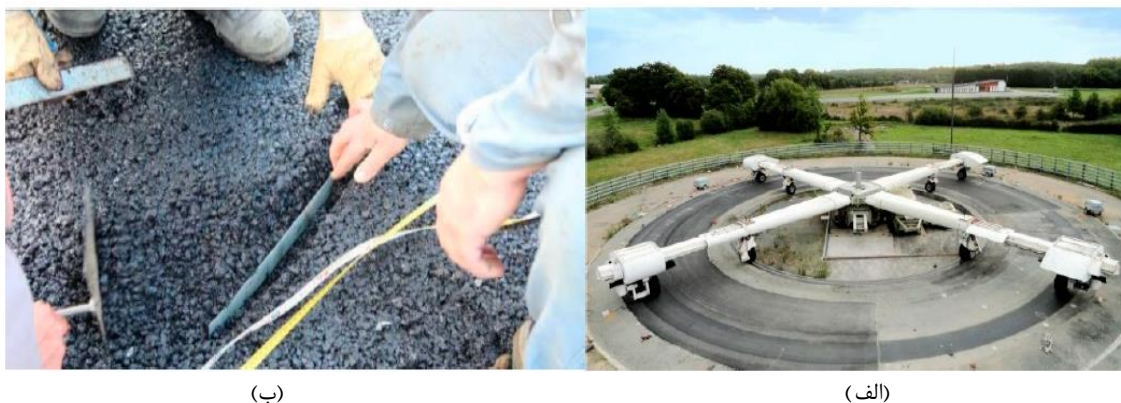
شکل ۴- الف) تجهیزات آزمایش تسریع شده‌ی روسازی (APT) در موسسه‌ی IFSTTAR ب) نصب کابل‌های فیبر نوری در آسفالت [۳۰]
