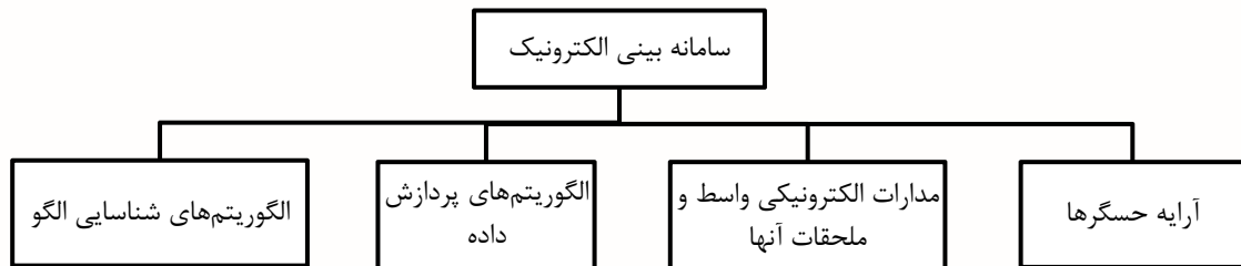
شکل (۱). اجزاء اصلی یک سامانه بینی الکترونیک
