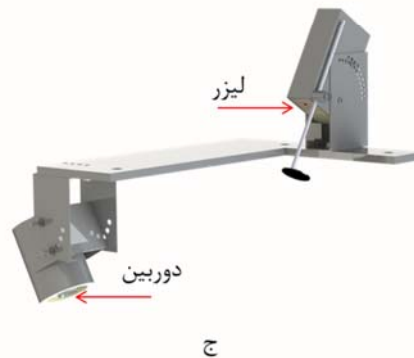
شکل ۳- سیستم طراحی شده برای تشخیص و اندازه‌گیری سایش شامل لیزر خطی و دوربین صنعتی نصب شده بر روی ترولی قابل حرکت بر روی خطوط ریلی، الف) تصویر واقعی، ب) مدل رایانه‌ای و ج) فیکسچر لیزر و دوربین طراحی شده.
