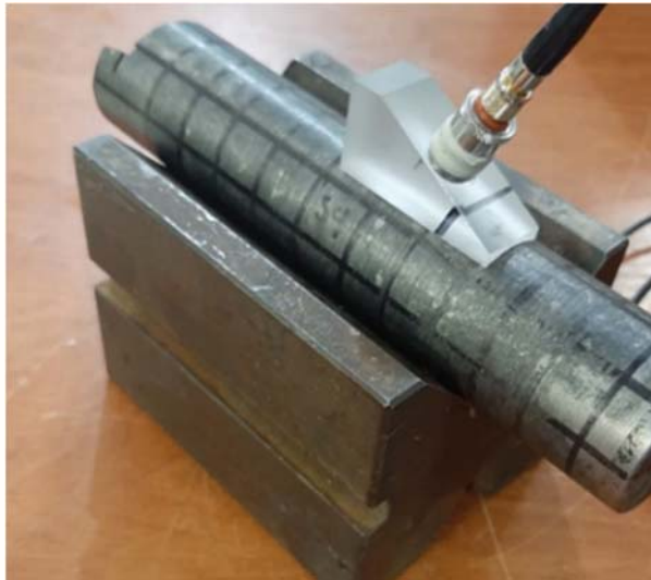
شکل ۲: موقعیت‌دهی کاوند و کفشک نسبت به قطعه
