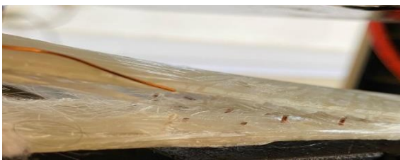
شکل ۵- نمایی از رشد ترک جدایش در نمونه Z-پین
