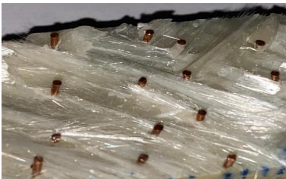
شکل ۱۰- نمایی از ناحیه پین گذاری شده در نمونه Z-پین مسی
