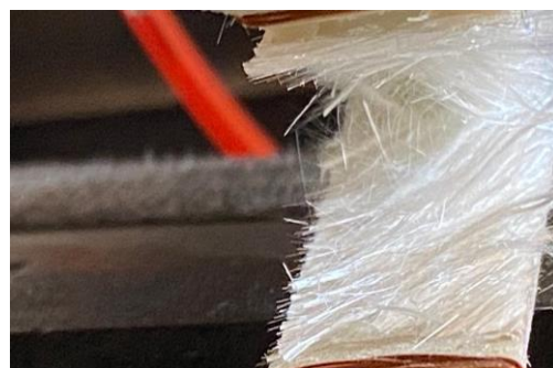
شکل ۲۳- نمایی از پشت جبهه پیشانی ترک و محل وقوع پل زنی الیاف
