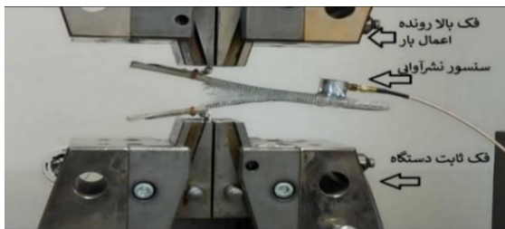
شکل ۳- نحوه ی قرارگیری نمونه بر روی دستگاه کشش در بارگذاری مود I
