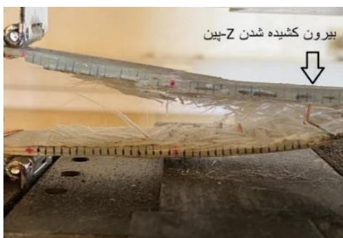
شکل ۱۹- بیرون کشیده شدن Z-پین و رشد زیگزاگی ترک جدایش بین لایه‌ای در نمونه پین گذاری شده
