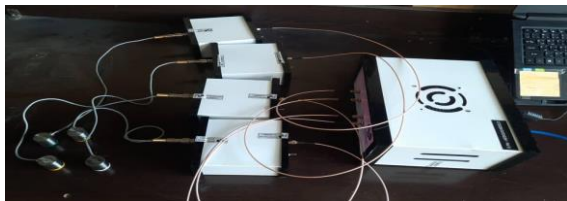
شکل ۴- اجزای دستگاه آکوستیک امیشن شامل سنسور و پیش تقویت کننده و پردازشگر
