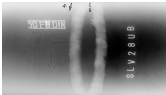
شکل ۱. پرتونگاره دو لوله متصل شده با جوشکاری
