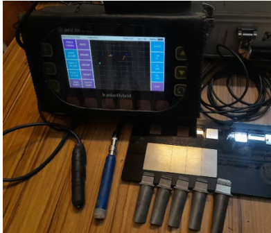
شکل ۸) تصویر دستگاه آزمون جریان گردابی در زمان انجام تست.
