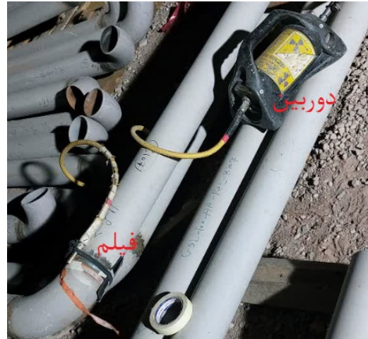
شکل (۱) چیدمان برای پرتونگاری گاما
