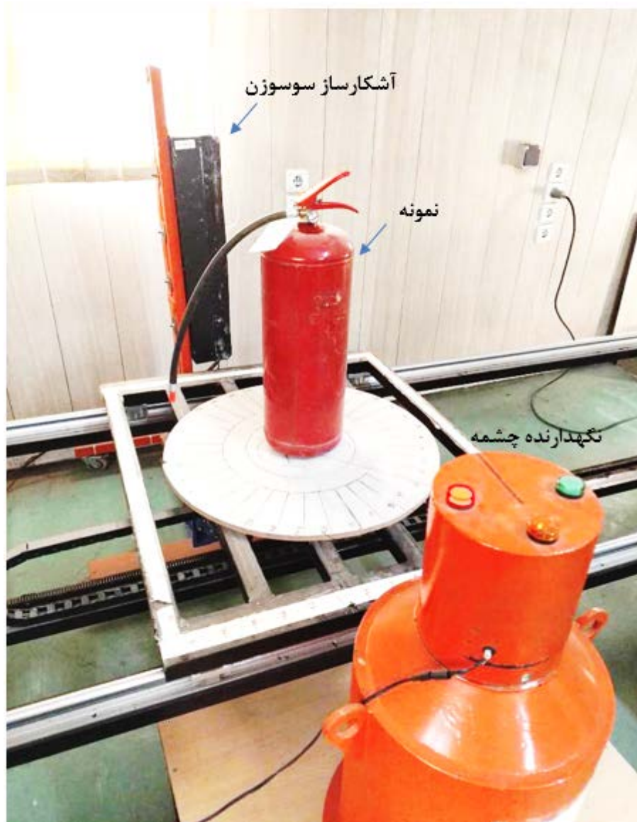
شکل ۲) چیدمان تجربی جهت بازرسی سیلندرهای آتش‌نشانی
