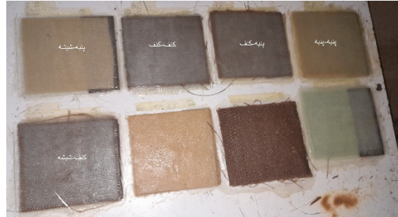
شکل ۲ نمونه‌های ساخته شده بصورت مستطیلی با لایه چینی‌های مختلف
