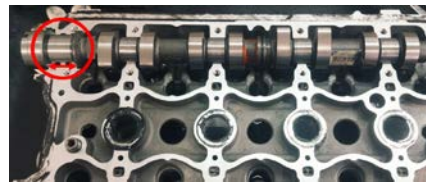
شکل (۱) میل بادامک و جایگاه نشست آن بر روی سرسیلندر و معرفی تراست سرسیلندر (کادر قرمز رنگ).
