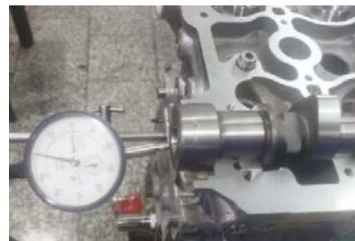
شکل (۲) بررسی اندازه لقی محوری میل بادامک به کمک ساعت اندازه‌گیری.
