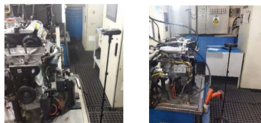
شکل (۳) (الف و ب) نحوه اندازه‌گیری صدای موتور در مرحله تست گرم انتهای خط تولید با دستگاه ZOOM H4n.
