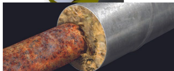
شکل (۱) خوردگی زیر عایق (CUI)
