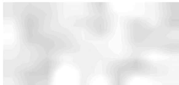
شکل ۹) تصویر نتیجه آزمون فراصوتی عبوری روبش-C نمونه شماره یک
