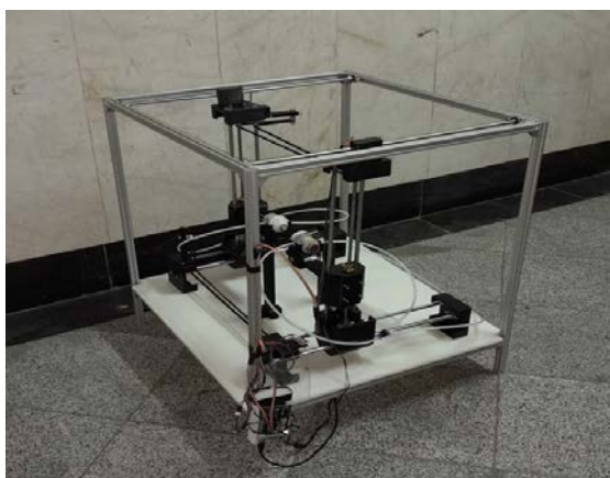
شکل ۸) تصویر سیستم آزمون فراصوتی - عبوری با تکنیک آبفشان
