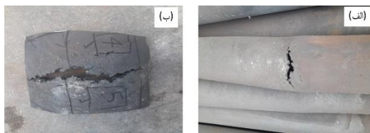
شکل ۲) الف) تصویری از برخی لوله‌های ریفورمر آسیب دیده و ب) نمونه برداری از یک لوله گسیخته شده برای تجزیه و تحلیل ریزساختاری.... ۲،۳. امکانات و روش ECT
