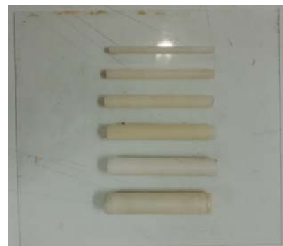
شکل ۴) فانتوم‌های ساخته شده پلی‌اتیلنی در بستر پلکسی‌گلاس
