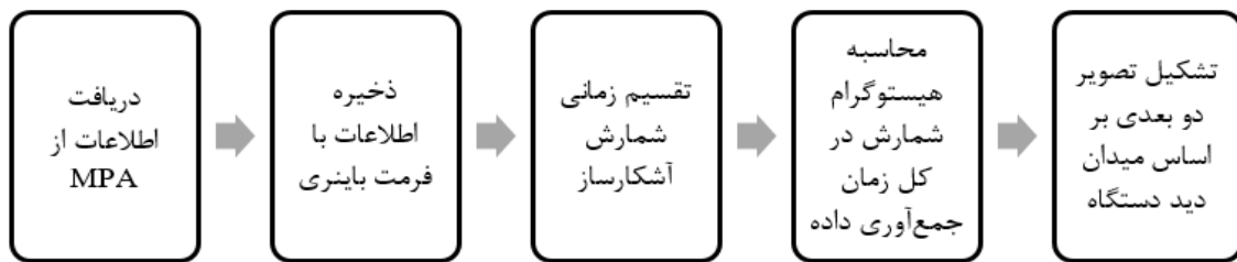
شکل ۳) روندنمای پردازش داده و تشکیل تصویر در دستگاه تصویربرداری پس‌پراکنشی.
