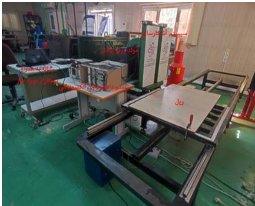
شکل (۲) نمای واقعی از دستگاه تصویربرداری پس‌پراکنشی ساخته‌شده در پژوهشگاه علوم و فنون هسته‌ای.
