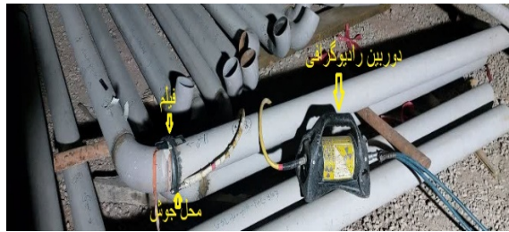
شکل (۱) چیدمان برای پرتونگاری لوله‌ها
