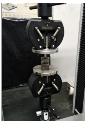
شکل ۳) چیدمان آزمون پانچ کوچک در دستگاه خستگی
