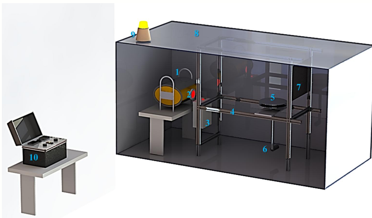
شکل ۲) نمای شماتیک از جانمایی تجهیزات در هندسه نهایی، (۱) مولد اشعه ایکس، (۲) پنجره خروجی باریکه ایکس، (۳) جعبه مدارهای کنترلی، (۴) سازه، (۵) محل استقرار نمونه-میز گردان، (۶) استپ موتور، (۷) آشکارساز صفحه تخت، (۸) اتاقک حفاظ پرتوی، (۹) چراغ هشدار سامانه و (۱۰) الکترونیک مولد ایکس
