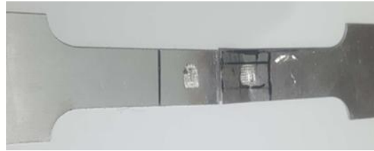
شکل ۵) سطح شکست نمونه دوم
