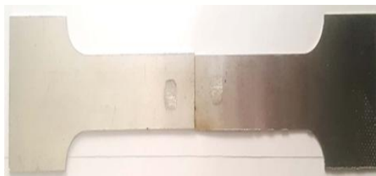
شکل (۴) سطح شکست نمونه جوشکاری یک
