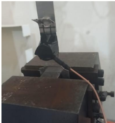
شکل ۱) نمونه در حال کشش و حسگر نشرآوایی
