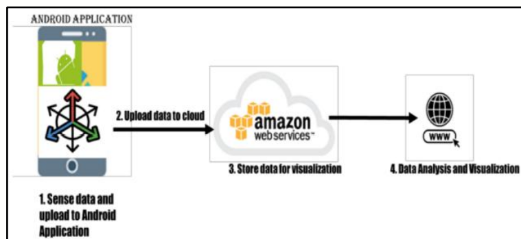
شکل ۳) شماتیک ارزیابی روش سامانه ابری چهار مرحله‌ای [۴۳]
