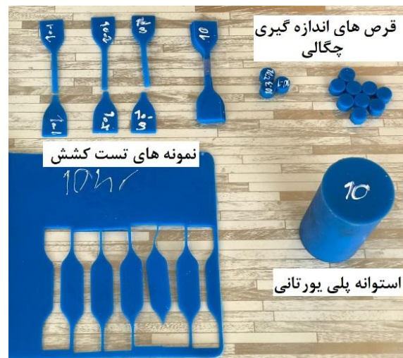
شکل ۳. نمونه آزمون پلی یورتانی و نمونه‌های آزمون کشش و قرص های اندازه گیری چگالی
