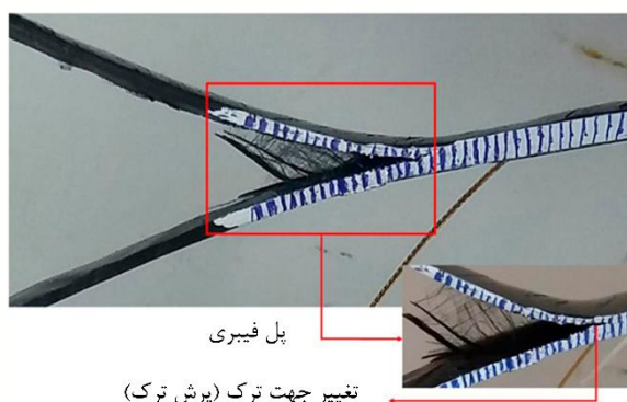
شکل ۵. پدیده‌ی پل زنی الیاف در نمونه‌ی مود DCB.
