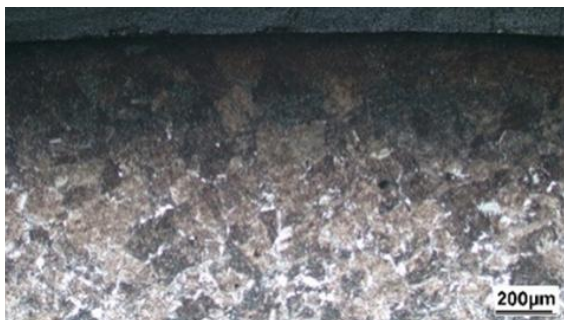
شکل (۱) ناحیه سخت‌شده در مقیاس ۲۰۰ میکرون.
