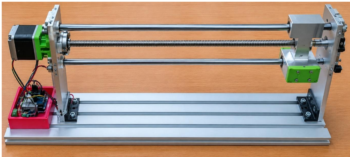
شکل ۷) دستگاه ساخته‌شده برای بررسی آزمون فراصوتی به روش روبش B
