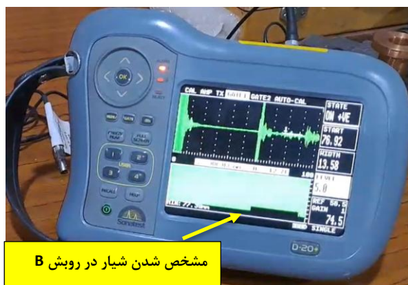
شکل ۱۴) روبش B برای تعیین موقعیت و عمق عیب در قطعه دارای سه شیار در حالت غوطه‌وری
