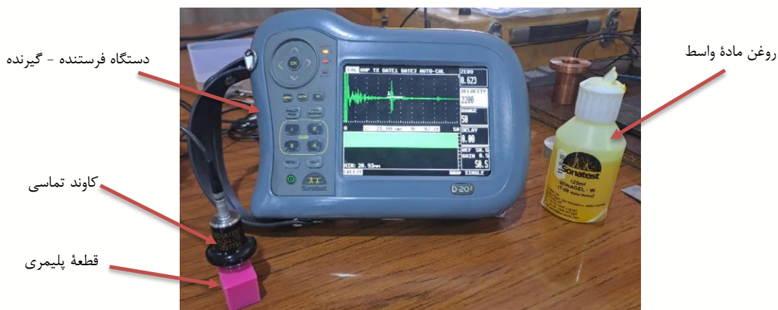
شکل ۸) تجهیزات و تنظیمات مورد استفاده برای اندازه‌گیری سرعت موج قطعه پلیمری
