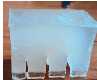
شکل ۶) قطعه با شیارهای متفاوت برای روبش B
