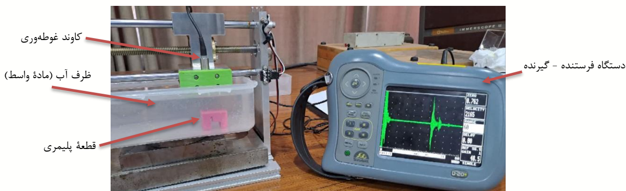
شکل ۹) ارزیابی سنج ساخته شده براساس بلوک V1 در روش غوطه‌وری
