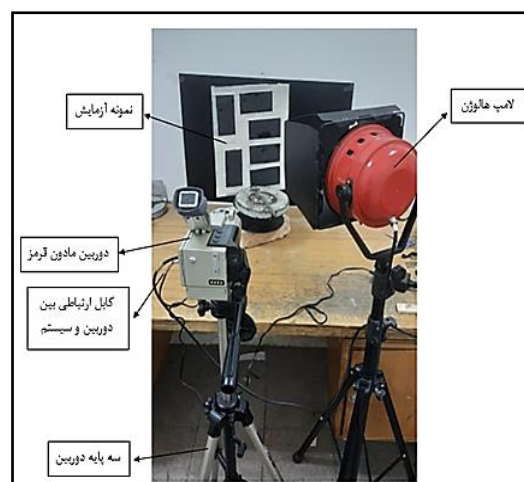
شکل ۹) چیدمان دوربین و لامپ هالوژن نسبت به نمونه
