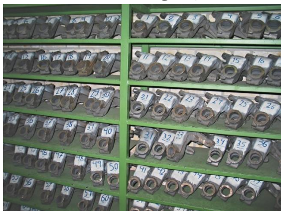
شکل ۲- نمونه‌های شاهد سگدست پژو برای معرفی به پایگاه داده سیستم رزونانس صوتی
