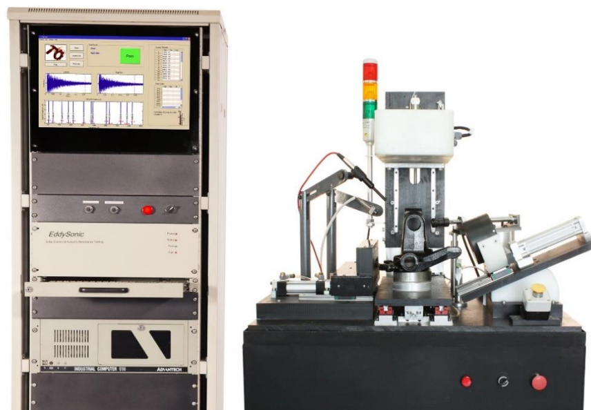
شکل ۱- سیستم رزونانس صوتی EddySonix® و دستگاه مکانیکی تست سگدست
