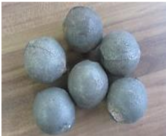
شکل (۱) گلوله‌های آسیا از جنس چدن پر کروم (قطر ۴۰ میلی‌متر).
