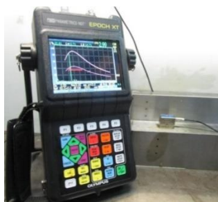
شکل ۴: رسم منحنی فاصله-تقویت-اندازه با استفاده از دستگاه فراصوتی Olympus EPOCH-XT
