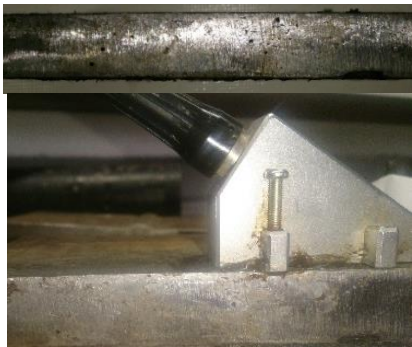
شکل ۷: مجموعه آزمایشی پروب تخت و قطعه فولادی
