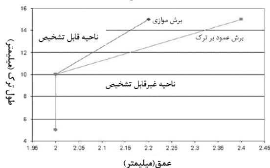
شکل ۸. قابلیت برش‌نگاری در تشخیص ترک نمونه آلومینیومی. [۱۳]
