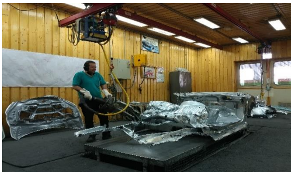
شکل ۹- تخریب بدنه محصول رانا توسط اپراتور با دستگاه گان هیدرام جهت ارزیابی جوش مقاومتی نقطه‌ای
