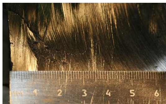
شکل ۷- نمایی از خط جوش ۱۱۱ و ترک بوجود آمده درون آن در نیروگاه زاپاروسکی اکر این سال ۲۰۱۰.
