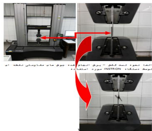
شکل ۱۱- دستگاه تست کشش - برش مورد استفاده در آزمایش
