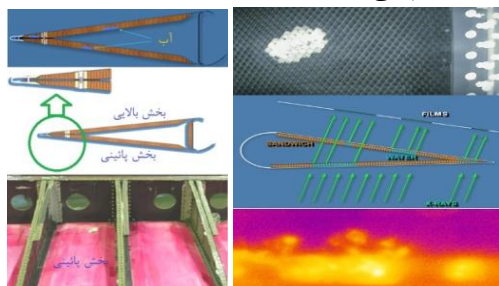
شکل (۲) ترموگرافی جایگزینی مناسب برای کشف آب در سازه‌های ساندویچی لانه زنبوری
