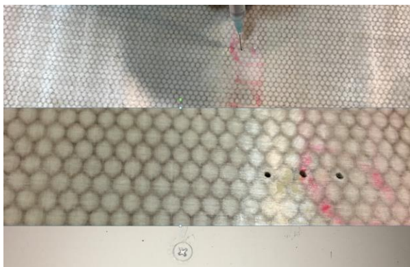
شکل (۶) ایجاد عیوب ظاهری و تزریق آب (ایجاد عیوب مصنوعی)
